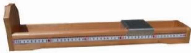
► Appareil de mesure de la longueur de la patte arrière des ongulés : Guyapon
